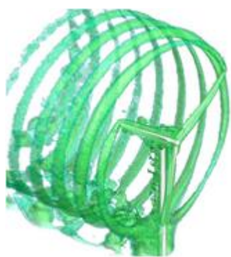
流固耦合模擬風機轉動所形成之尾流效應。
