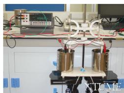
Sir William Thomson (或 Lord Kelvin)於十九世紀中葉研究雷雨和大氣靜電效應時，提出利用靜電感應原理使水滴帶電，並藉由重力蒐集帶電之水滴，在短時間內蓄積大量電荷以供後續放電之用。然而，過去一百五十餘年來，並未有研究者就 Kelvin 水滴發電裝置之整體，從蓄電時間快慢的角度進行蓄電最佳化的探討。本團隊率先針對 Kelvin 水滴發電裝置，因幾何構型及尺寸變化所造成的蓄電時間快慢差異進行量測，並探究蓄電最佳化所需的裝置幾何條件。實驗結果顯示，當感應電極表面積越大或距離水滴形成處越近時，單位時間所得之電位升會越大。另外，藉由提升壓力頭來增加水滴流量亦有助於電荷之快速蓄積。然而，水滴流量過高將會使水滴形成處遠離感應電極，進而降低蓄電率。
