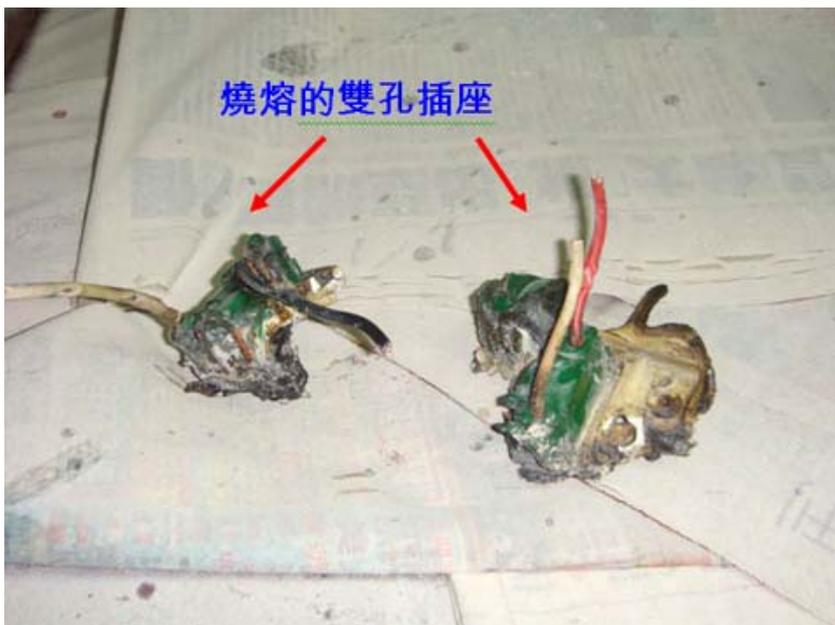
(二) 頂樓加壓泵浦反覆連續啟動，造成馬達機體溫昇及瞬間啟動電流上升，接線盒內配線披覆受損，短路起火。
