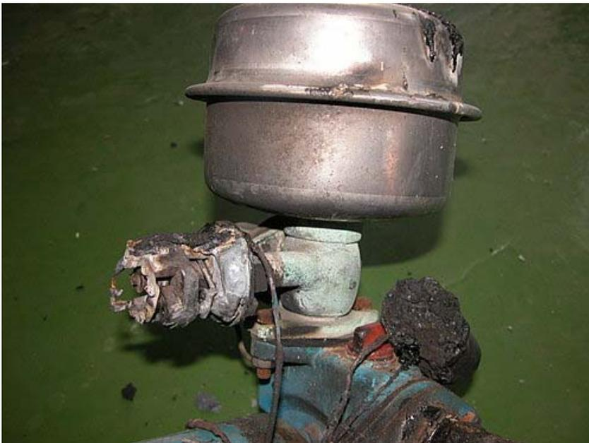
泵浦的壓力開關塑膠外殼燒熔
