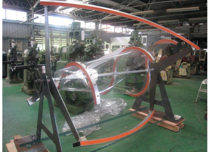
圖 7 豐能一號垂直軸阻力式小型風力發電機
