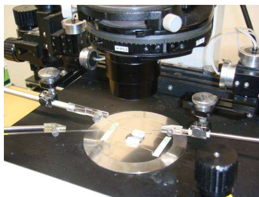
動物的肌肉組織放置於顯微鏡平台上實際觀察，該設備為Prof. Ishiwata實驗室自行改裝，以符合實驗需求。
