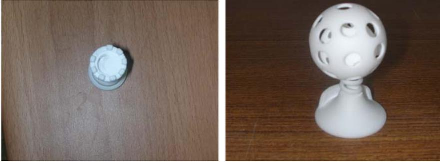
在上面右側圖形中，下部之螺旋部份為可拉深壓縮，球型工件內側中亦可在建構一球型工件。
