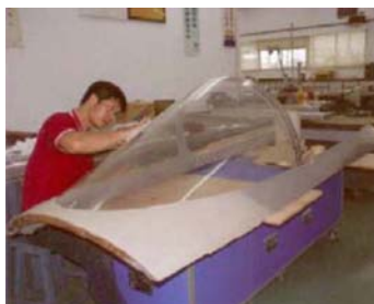
(圖7)漢翔公司具備免 模具PC 板成型技術
